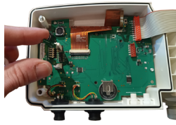
如图, 将无线通讯模块 插入到支架中
