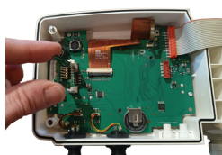
Segurar o módulo de comunicação sem fios entre os dedos, como indicado na imagem, e fazê-lo deslizar entre os dois suportes.
