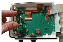
Sujete el módulo de comunicación inalámbrica con los dedos tal como se indica en la imagen y deslicelo entre los dos soportes.
