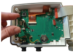
Tenere il modulo di comunicazione wireless tra le dita come mostrato nell'immagine e farlo scorrere tra i due supporti.
